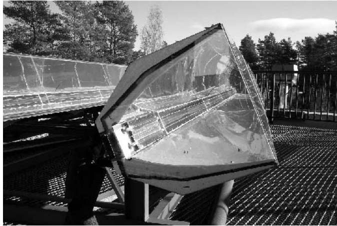
Figur 2.9 Koncentrerande hybrid med både solfångare och solceller. Den glasade gavel förhindrar skuggning av de yttersta solcellerna. [Foto: Nilsson M.]
