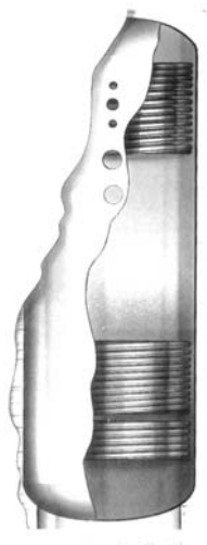
Figur 3.1 Akkumulatortank för värmelagring där vatten värms på två nivåer inuti tanken. [Andrén L. 1]
