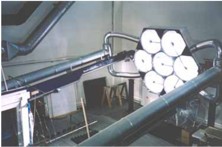
Figur 3.2 Den höj- och sänkbara solsimulatorn i laboratoriet på LTH. Lamporna ger nästan parallellt ljus och ljusets spektrum är relativt likt solens. Glasrutan framför lamporna filtrerar bort UV-strålningen och det mesta av den långvågiga strålningen.
